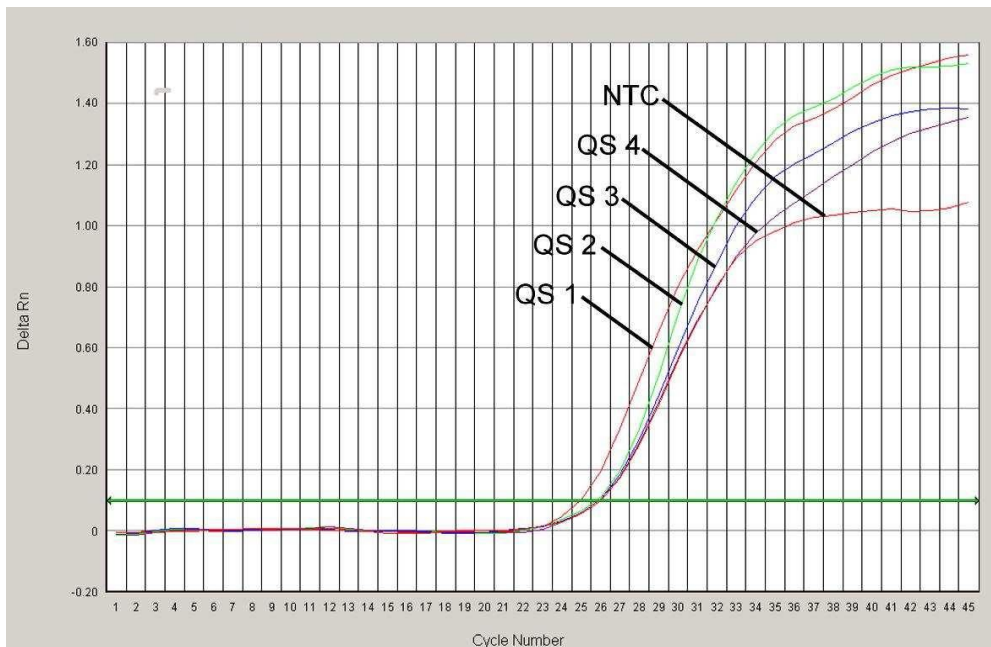
Fig. 23: Rilevazione del Controllo interno (IC) mediante la rilevazione di un segnale di fluorescenza VIC ( ABI PRISM 7000 SDS ) con contemporanea amplificazione degli Standard di quantificazione ( HSV2 LC/RG/TM QS 1 - 4 ). NTC: non-template control (controllo negativo).
