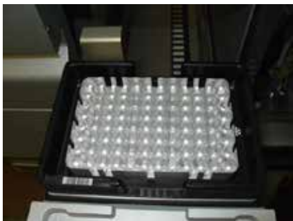
Auf dem Transfer-Rahmen in Stellplatz 1 der „Eluat“-Schublade platzierter Adapter.
