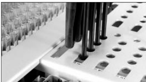
Tip-Guards helfen, Kreuzkontaminationen zu vermeiden.
