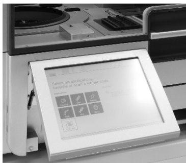
Figura 19. Pantalla táctil extraíble del QIAcube Connect MDx
