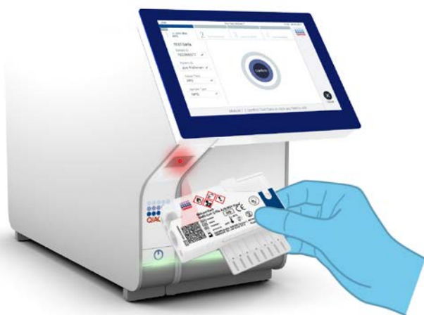
12. attēls. QIAstat-Dx SARS-CoV-2/Flu A/B/RSV Panel Cartridge kasetnes svītrkoda skenēšana.
