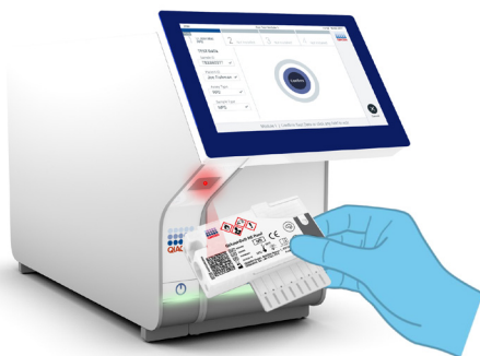
12. ábra: A QIAstat-Dx Meningitis/Encephalitis Panel Cartridge vonalkódjának beszkenelése.
