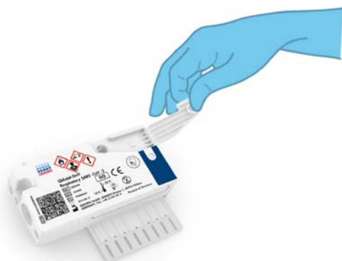
Obrázek 19. Otevření víčka na alikvoty v hlavním portu.
