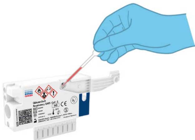
Obrázek 21. Přenos alikvoty do hlavního portu kazety QIAstat-Dx Respiratory SARS-CoV-2 Panel Cartridge.
