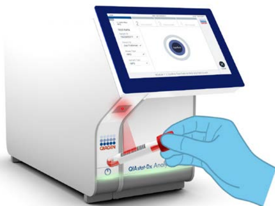
Obrázek 24. Skenování čárového kódu s ID alikvotu.
