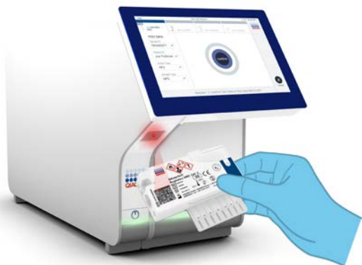
Obrázek 25. Skenování čárového kódu kazety QIAstat-Dx Respiratory SARS-CoV-2 Panel Cartridge.
