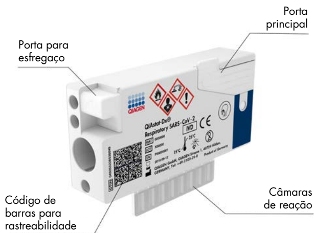
Figura 1. Disposição do QIAstat-Dx Respiratory SARS-CoV-2 Panel Cartridge e respetivas funcionalidades.
