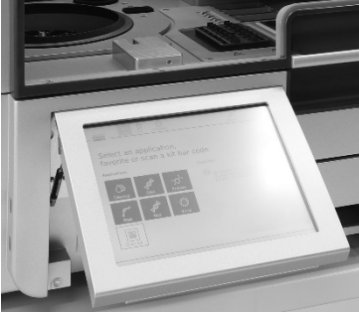
Şekil 19. QIAcube Connect MDx cihazının dışarı çekilmiş dokunmatik ekranı
