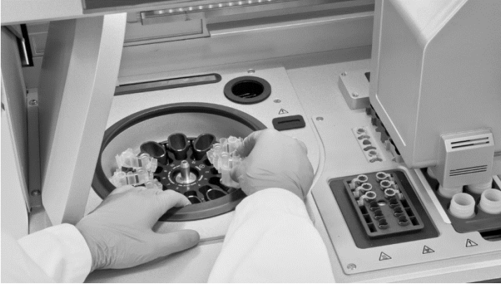
Şekil 25. QIAcube cihazları üzerinde santrifüjü yükleme. Kurulu rotor adaptörlerini santrifüj kovalarına yükleyin (örnek olarak QIAcube Connect MDx gösterilmektedir).
