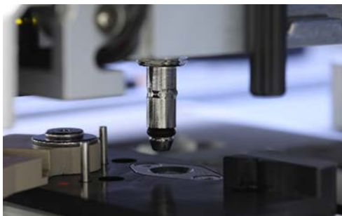
Verificar se o novo O-ring está bem encaixado
