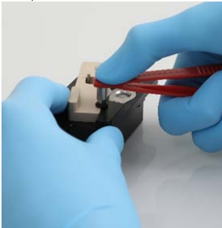
Pressionar a cavilha com a parte traseira da pinça
