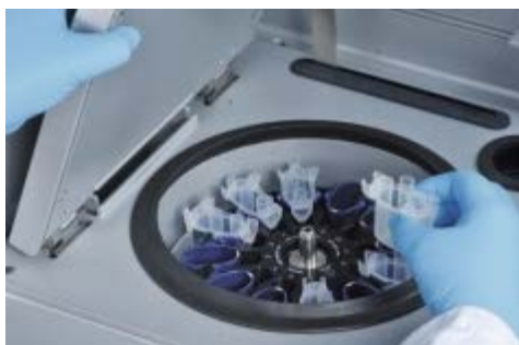
Remover os adaptadores do rotor
