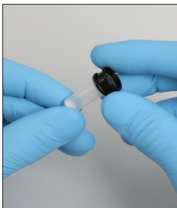
Colocar um anel adaptador da coluna de rotação.
