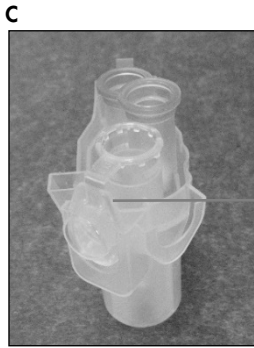
Tampa do tubo de microcentrifugação de 1,5 ml não encaixada na ranhura
