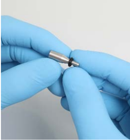
Deslizar o novo O-ring
