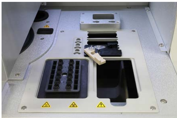
Carregar a ferramenta de O-ring
