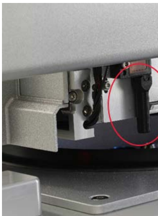
Colimador de feixe preto (ver círculo vermelho) do sensor ultrassónico
