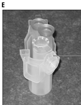
A tampa do tubo de microcentrifugação de 1,5 ml encontra-se na ranhura errada do adaptador do rotor
