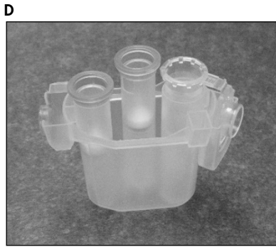
Tampa do tubo de microcentrifugação de 1,5 ml não encaixada na ranhura
