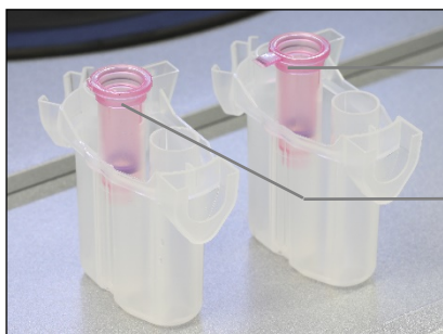
Comparação de tampas de coluna removidas de forma correta e incorreta
