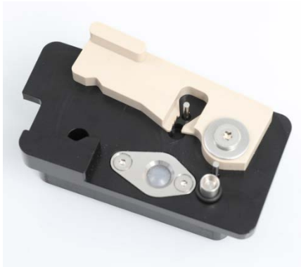
Ferramenta de O-ring com o novo O-ring preparado
