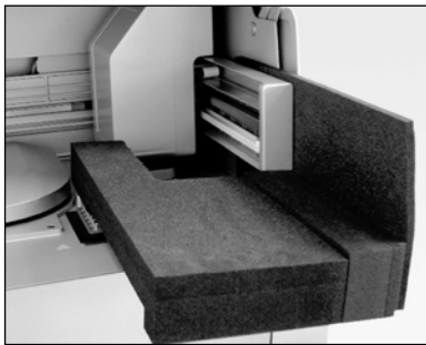
Proteção de espuma do braço robótico.
