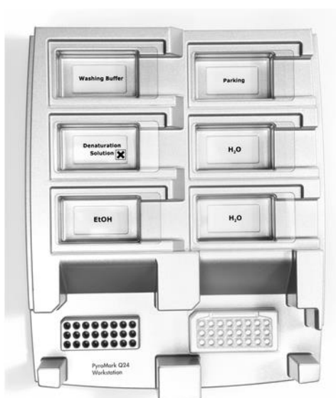
Bild 2. Placering av PCR-platta (eller remsor) och PyroMark Q24-platta på vakuumbstationen.
