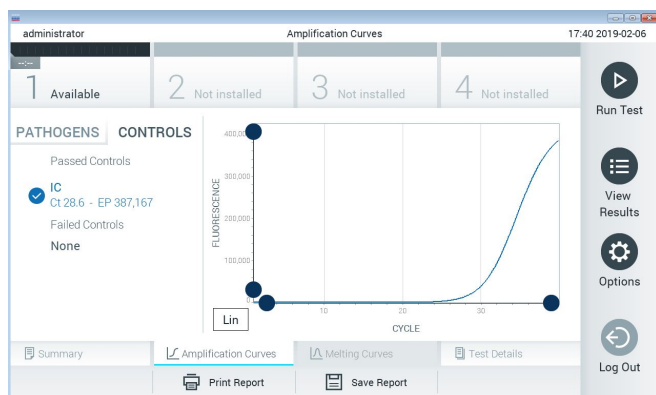
Figura 18. Schermata Amplification Curves (Curve di amplificazione) (scheda CONTROLS (CONTROLLI)).
