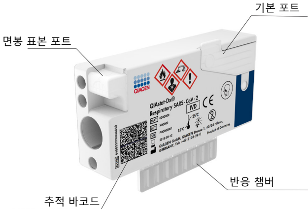
그림 1. QIAstat-Dx Respiratory SARS-CoV-2 Panel Cartridge 의 구조 및 기능
