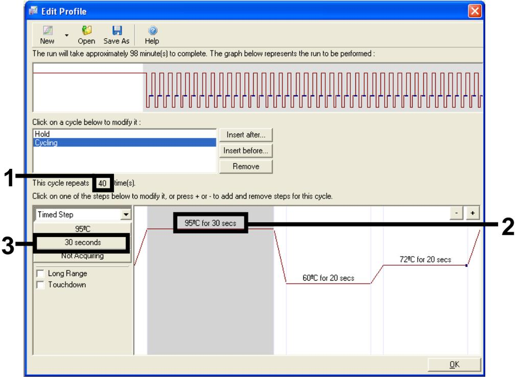
Figura 26. Passaggio di ciclaggio a 95°C. 1 = casella "Cycle repeats"(Ripetizioni ciclo); 2 = impostazione della temperatura del primo passaggio; 3 = impostazione della durata del primo passaggio.
