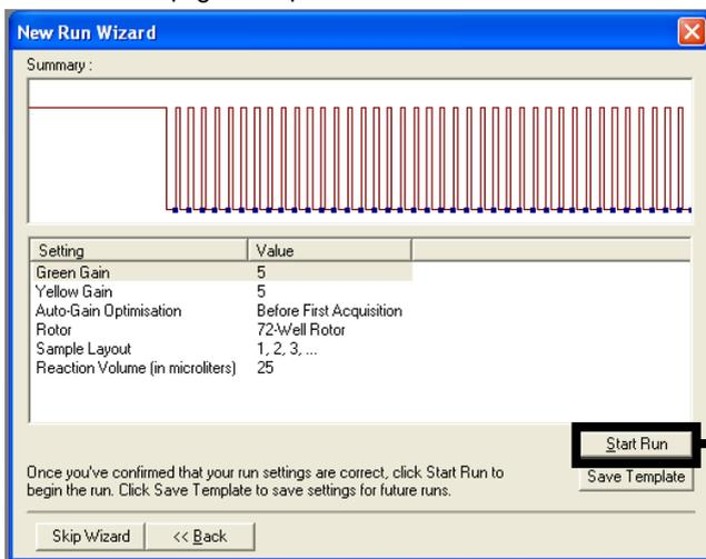
Figura 36. Finestra di dialogo "New Run Wizard" (Procedura guidata nuovo processo). 1 = "Start Run" (Avvia seduta).
