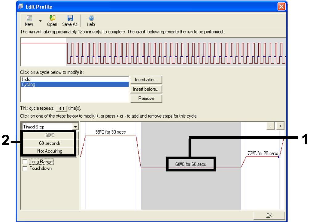
Figura 27. Passaggio di ciclaggio a 60°C. 1 = impostazione della temperatura e della durata del secondo passaggio; 2 = "Not Acquiring" (No acquisizione).
