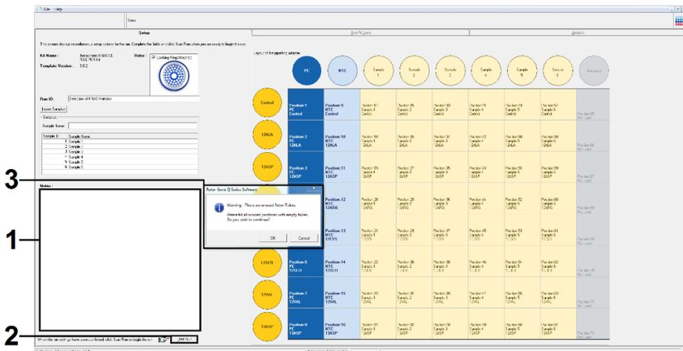
Figura 15. 1 = campo "Notes" (Annotazioni); 2 = "Start Run" (Avvia seduta); 3 = "Warning" (Avvertenza) relativa alle posizioni del rotore inutilizzate.
