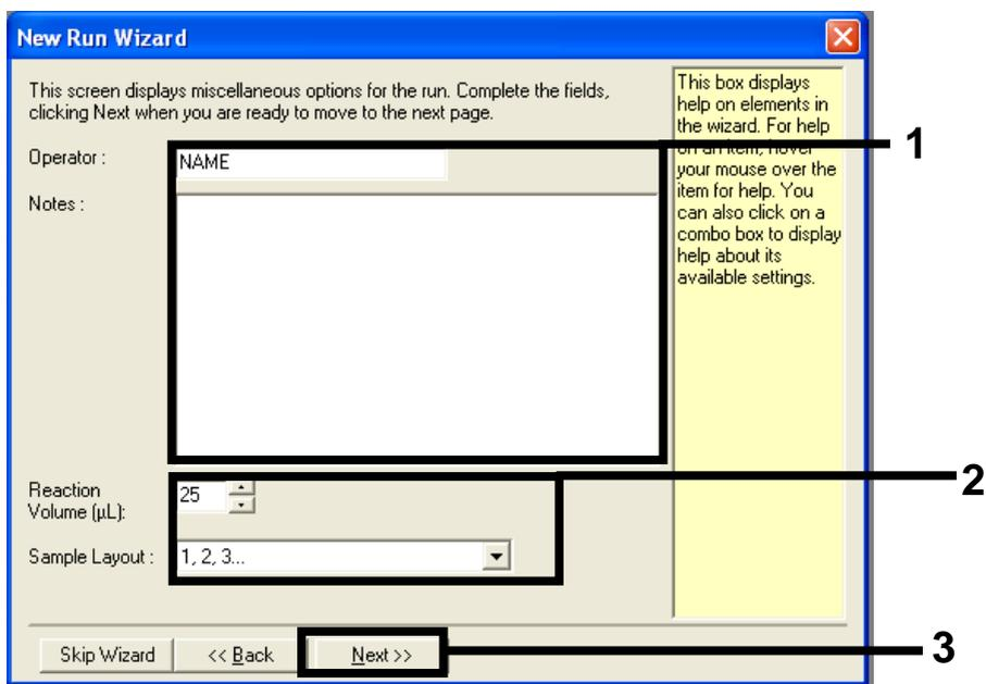
Figura 34. Finestra di dialogo "New Run Wizard" (Procedura guidata nuovo processo). 1 = campi "Operator" (Operatore) e "Notes" (Annotazioni); 2 = campi "Reaction Volume" (Volume reazione) e "Sample Layout" (Configurazione campioni); 3 = "Next" (Avanti).
