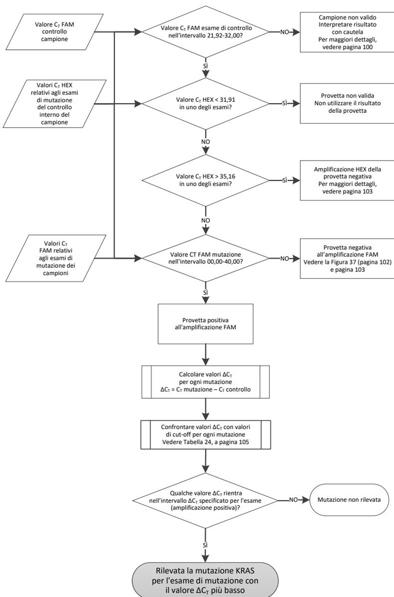
Figura 38. Diagramma di flusso per l'analisi dei campioni.
