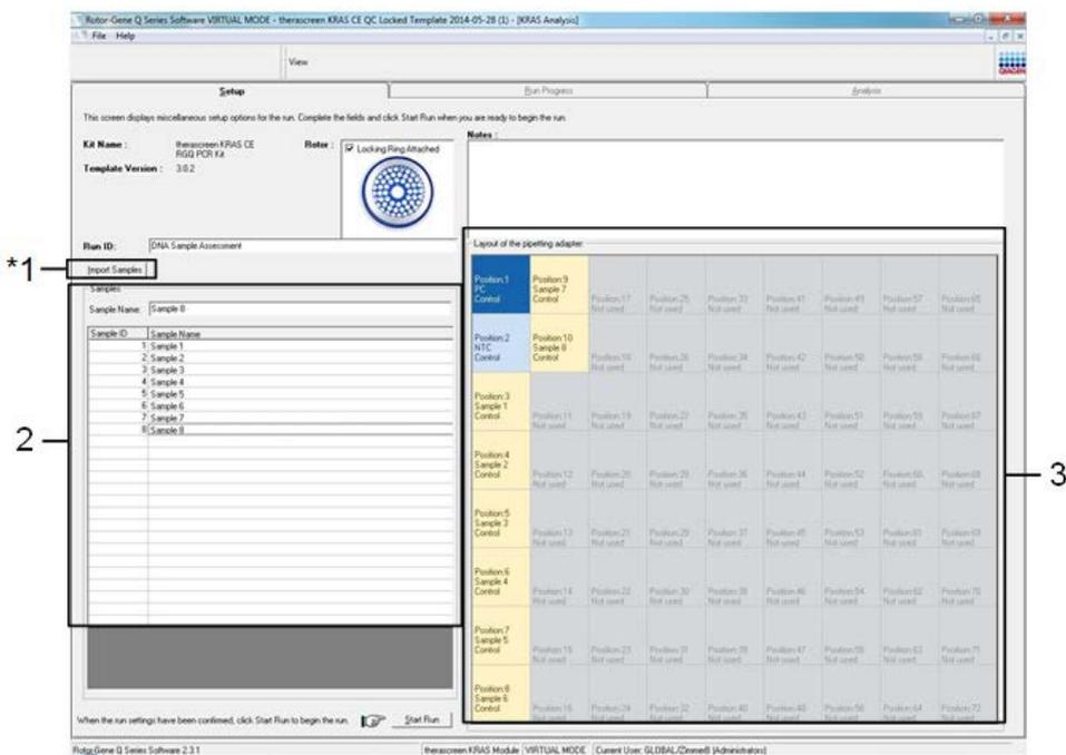
**Figura 4. Immissione di altri nomi di campioni nel campo "Sample Name" (Nome campione).** \*1 = pulsante "Import Samples" (Importa campioni); 2 = campo "Sample Name" (Nome campione) ed elenco campioni; 3 = riquadro "Layout of the pipetting adapter" (Configurazione dell'adattatore di pipettamento) con ulteriori nomi di campioni.
