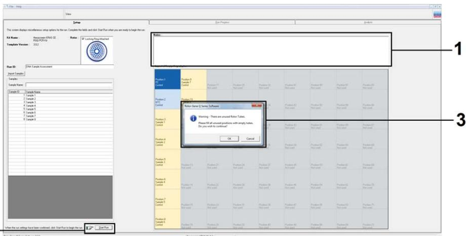
Figura 14. Immissione di altri nomi di campioni nel campo "Sample Name" (Nome campione). 1 = campo "Sample Name" (Nome campione); 2 = elenco campioni; 3 = riquadro "Layout of the pipetting adapter" (Configurazione dell'adattatore di pipettamento) con ulteriori nomi di campioni.
