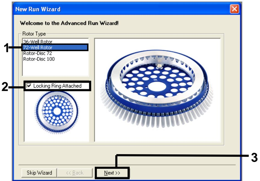
Figura 21. Finestra di dialogo "New Run Wizard" (Procedura guidata nuovo processo). 1 = "Rotor Type" (Tipo rotore); 2 = casella "Locking Ring Attached" (Anello bloccante collegato); 3 = "Next" (Avanti).
