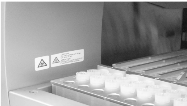
Symboler för biologisk fara och värmefara nära spetsstället.
