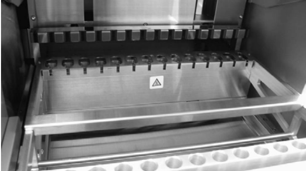
Symbol för värmefara på uppvärmningssystemet.
