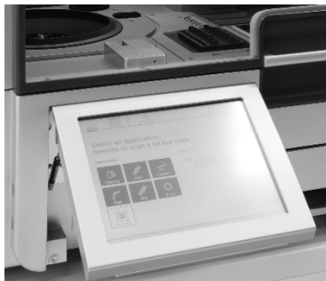
19. attēls. QIAcube Connect MDx skārienekrāns izvilkta stāvoklī
