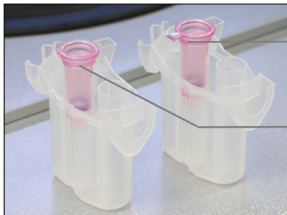
Sammenligning af korrekt og forkert fjernede kolonnelåg
