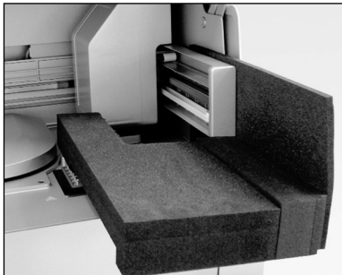
Skum ilagt mellem centrifugen og robotarmen
