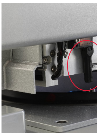
Ultralydssensorens sorte strålekollimator (se rød cirkel)
