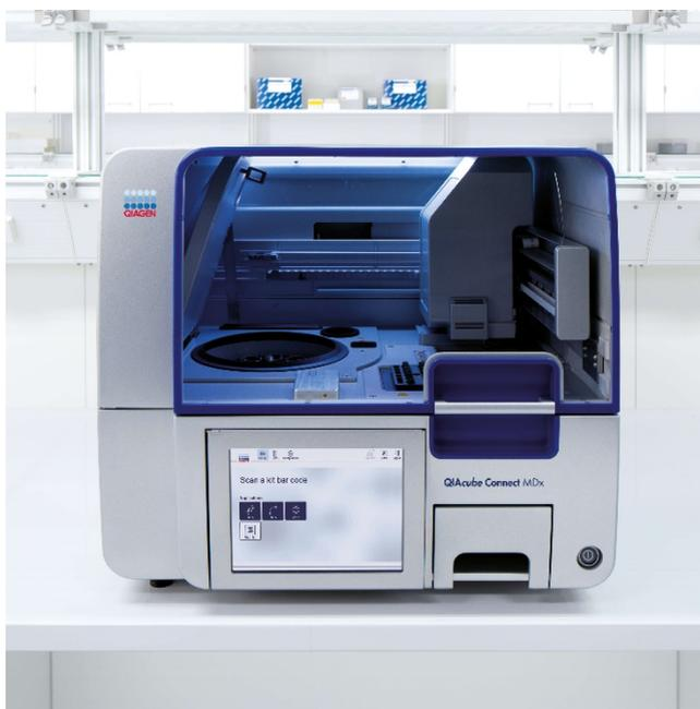
**Figura 2.** El instrumento QIAcube Connect MDx.
