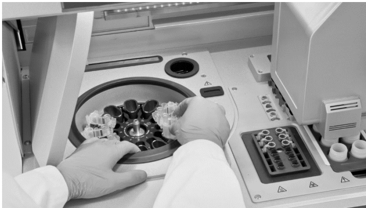
Figure 23. Chargement de la centrifugeuse sur les instruments QIAcube. Chargez les adaptateurs de rotor assemblés dans les godets de la centrifugeuse (QIAcube Connect MDx illustré ici).
